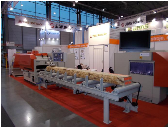
Středící dopravník DWS 3 s dvouhřídelovou rozmítací pilou PWR 412
